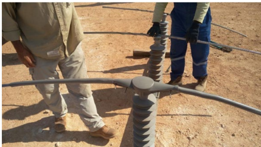
Figura 4.22. Los revestimientos formados por piezas preformadas son el tipo de aislamiento más utilizado. La silicona es uno de los materiales utilizados para fabricar estas piezas, ya que aporta gran resistencia y durabilidad. © Imad Kanouni
