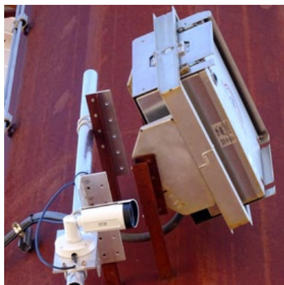
Figura 5.22. Cámaras de visión inteligente instaladas en una torre de transmisión para monitorear colisiones. © James F. Dwyer y Richard E. Harness
