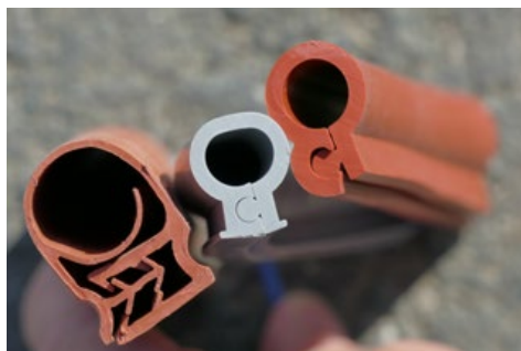
Figura 4.29. La calidad de los materiales y piezas utilizadas en la fabricación del aislamiento determina su eficacia y sobre todo su durabilidad. En la imagen se aprecia claramente que el aislamiento de la izquierda está construido con un material más robusto y tiene un sistema de fijación más seguro. © Justo Martín
