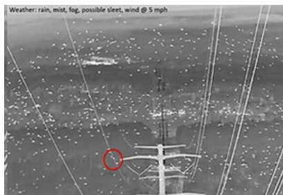
Figura 5.23. Sistema de cámaras que captura imágenes de video de numerosos passeriformes cruzando la línea de transmisión. © EDM Internacional, Inc.
