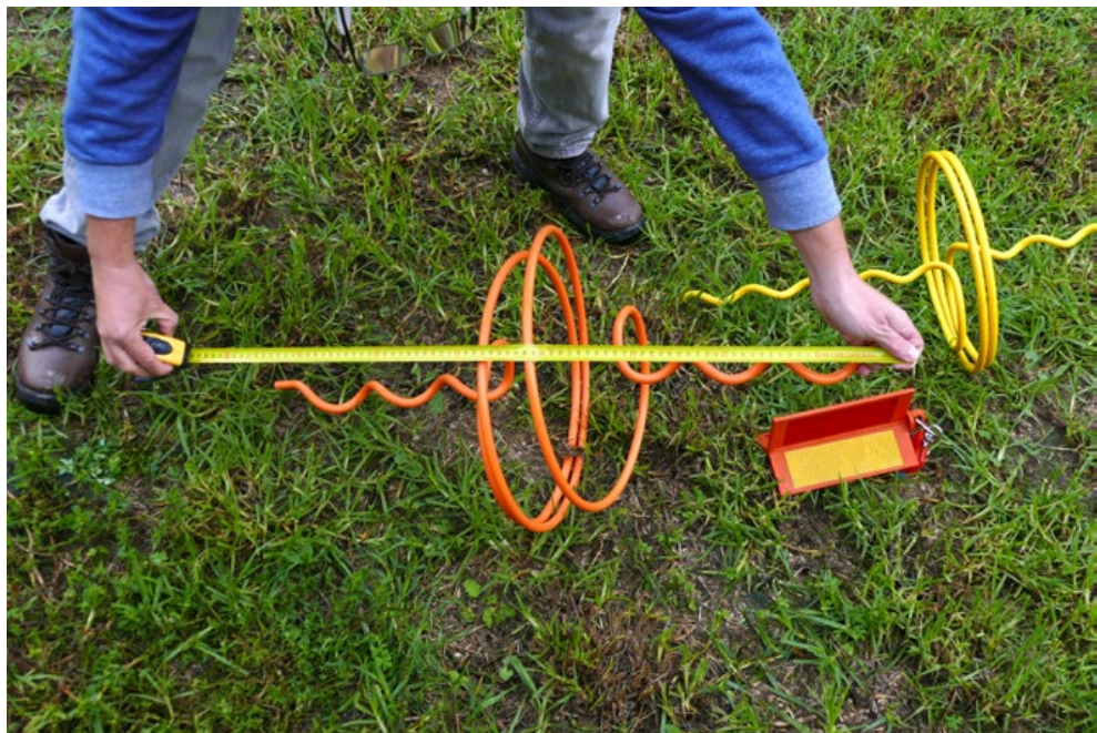
Figura B.3. Imagen comparativa de tamaño de señalizadores; la cinta métrica señala un metro. © Justo Martín
