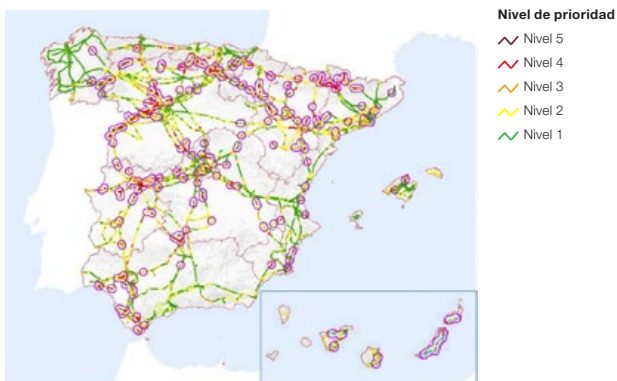
Figura 7.12. Nivel de prioridad para la señalización anticolisión en la red eléctrica española de transmisión (del 1 al 5, de menor a mayor). El mapa muestra los diferentes tramos de las líneas según el nivel de prioridad y las zonas donde se concentran los tramos con mayor nivel (marcadas en morado). © Redeia
